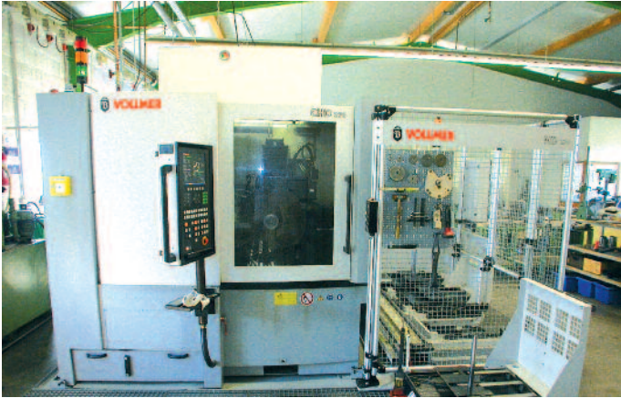
Robotersystem für die automatische Bestückung einer Schärmaschine mit bis zu 250 Kreissägeblättern bei Romi-Technik in Offenbach
