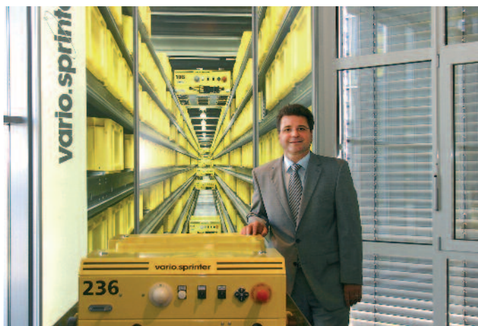
Werner Klein erläutert ein Shuttlesystem zur Beförderung von Warenkörben, das auch Bremsenergie voll nutzt und selbständig Strom nachtankt.
