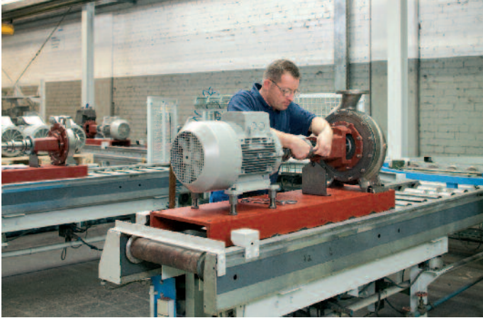
Ein KSB-Mitarbeiter richtet eine „Eta“-Pumpe und den Motor auf der Grundplatte aus.
