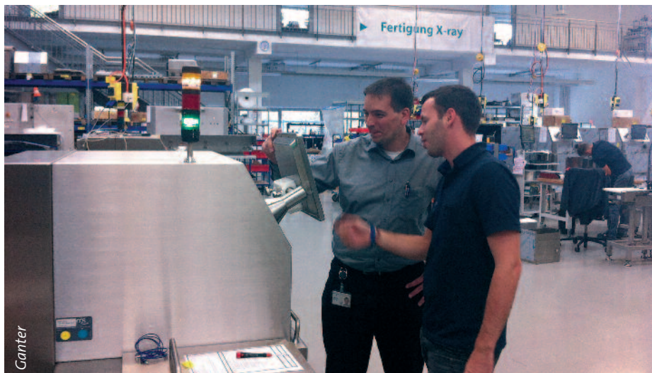
Michael Siegrist (links) und Softwareentwickler Jan Gaßen an einem Kombigerät, das sowohl wiegen als auch röntgen kann.
