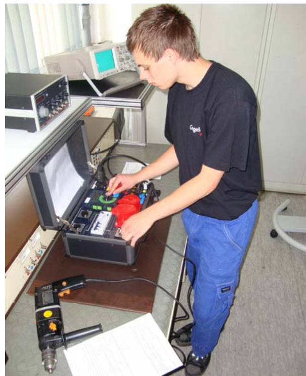
Abb. 2 1) : Wiederholungsprüfung an einem elektr. Gerät
