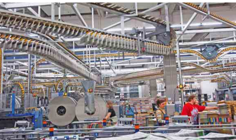
Im Versandzentrum werden die fertigen Druckerzeugnisse in den Vertrieb gegeben. Neue Maschinen können bis zu 13 Beilagen gleichzeitig zufügen. Foto: PR
