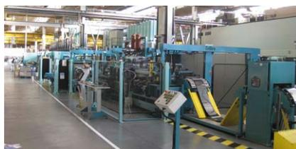
Anlagen zum Fertigen von Waschmaschinentrommeln
