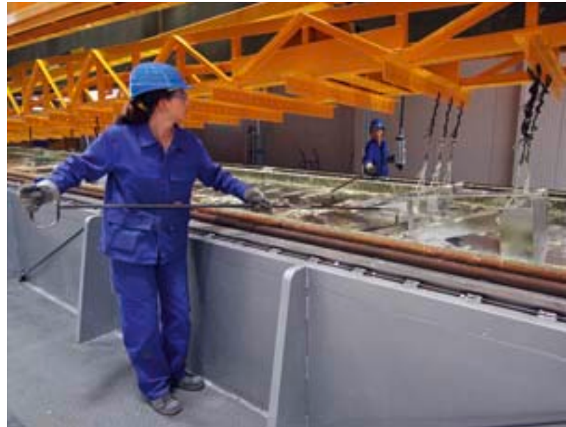
Eine unlösbare Verbindung, die vor Korrosion schützt: Das Verfahren der Feuerverzinkung.
