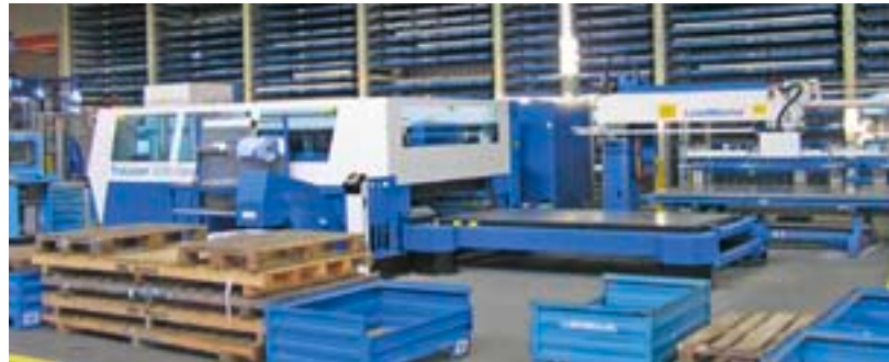
KUIPERS bedient die komplette Prozesskette Blech: Unser Foto zeigt eine automatisierte 6 kW-Laseranlage, im Hintergrund das Stopa-Hochregallager.
