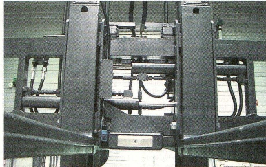
**Ware schnell erkannt:** In der Mitte des Stapler-Schlittens befindet sich das RFID-Lesegerät. Es sendet Funkwellen aus, sobald der Stapler eine Entfernung von 2 m zur Palette unterschreitet. Foto (2): ITA
