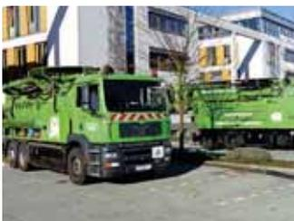
Modernste Saug- und kombinierte Saug-Spülfahrzeuge mit Wasserrückgewinnungstechnik werden für die Kanalreinigung eingesetzt.
