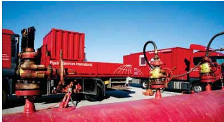
Typischer Aufbau einer Druckprüfung: Hochdruckmolchschleuse, Messwagen und Pumpeneinheit.
