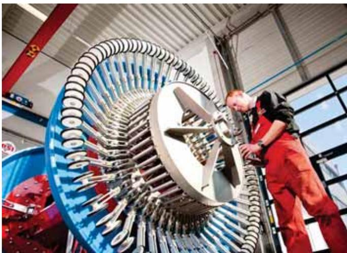
Der Geometriemolch DN 1400 zur Innenvermessung von Pipelines.
